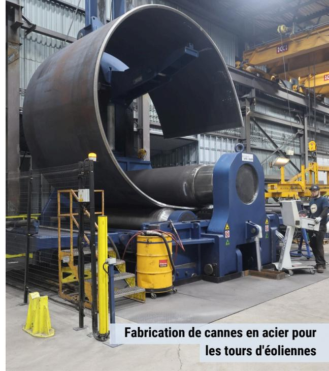
Fabrication de cannes en acier pour les tours d'éoliennes
