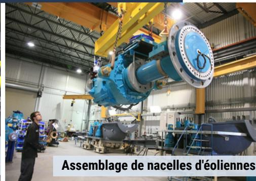
Assemblage de nacelles d'éoliennes
