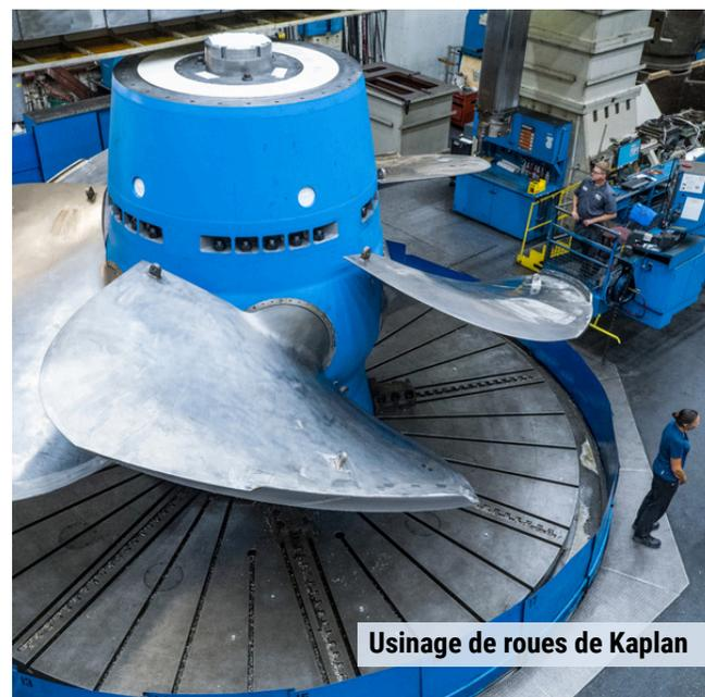
Usinage de roues de Kaplan
