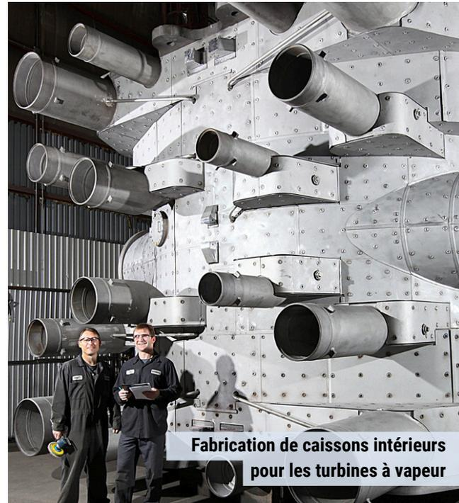
Fabrication de caissons intérieurs pour les turbines à vapeur
